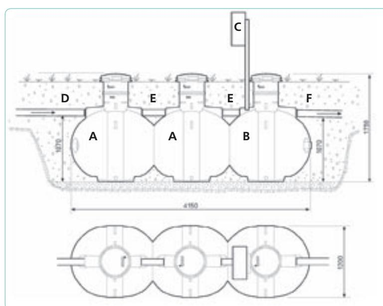
А – осадочные резервуары объемом (2x1м<sup>3</sup>)
