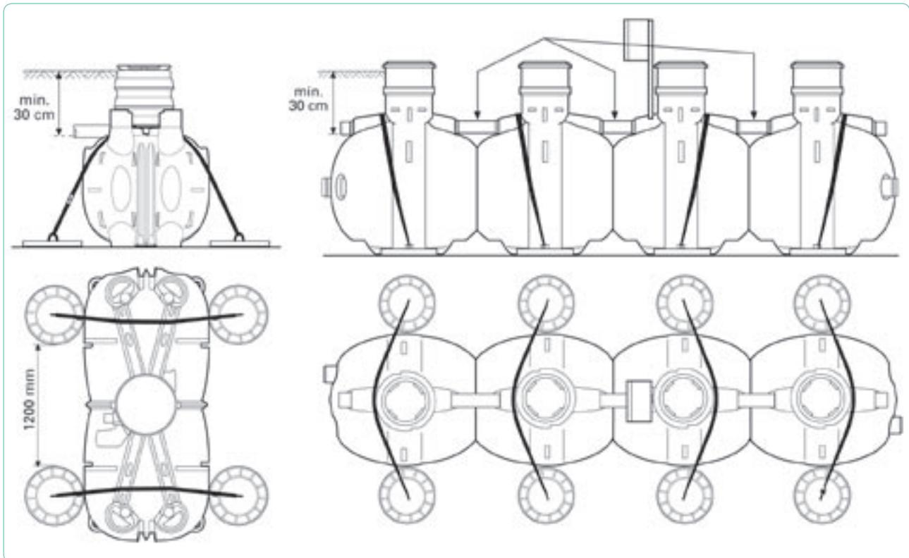
При выполнении монтажа анкерные плиты размещаются на ровной поверхности под резервуаром, плиты должны покрывать всю площадь основания, на которой устанавливается резервуар. Крепежные канаты натягиваются поверх резервуаров и крепятся к проушинам анкерных плит. Поверх анкерных плит добавляется примерно 20-ти сантиметровое песчаное уплотнение, после чего можно крепить крепежные канаты. В конце выполнения этой процедуры траншея заполняется и уплотняется.
