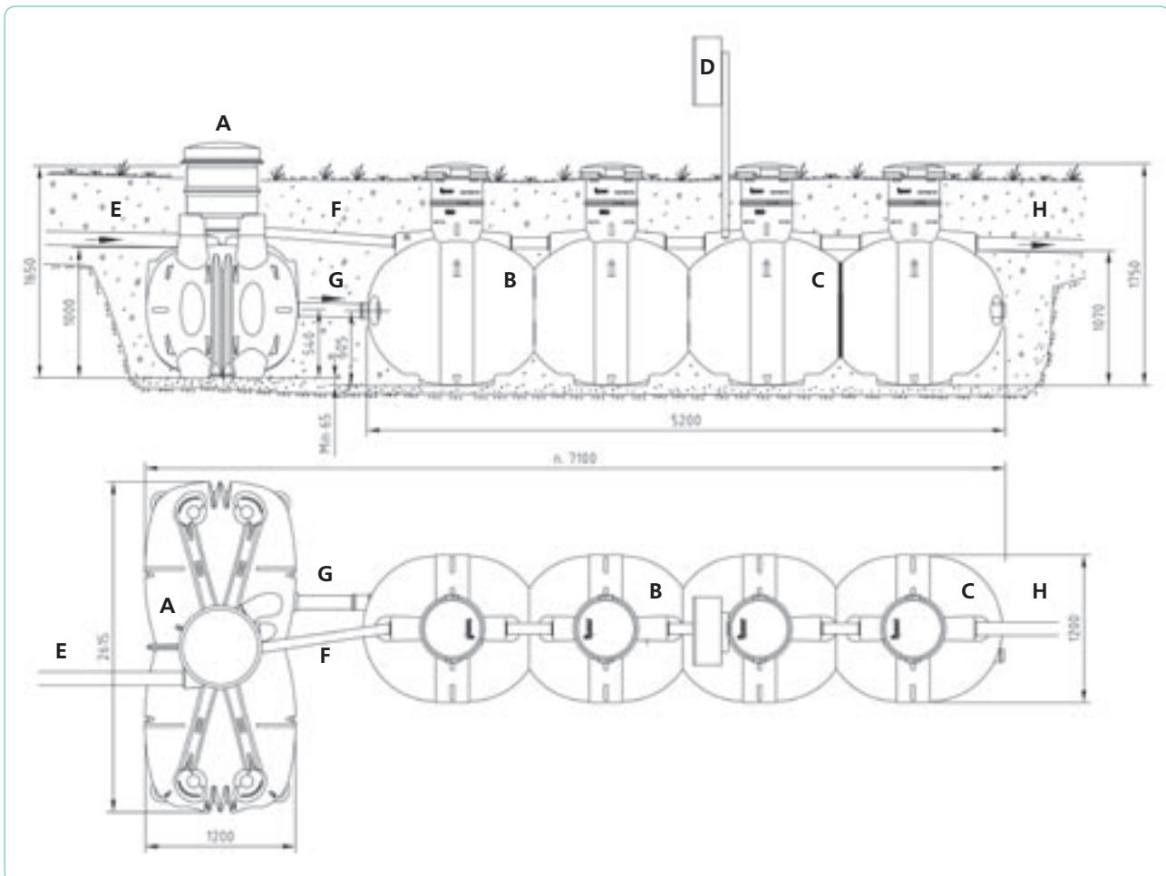
A – первичный осадочный резервуар объемом 2м<sup>3</sup>
