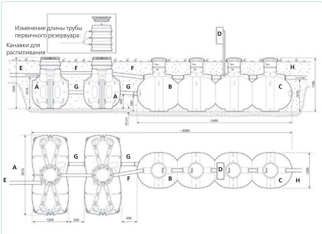
А – первичный осадочный резервуар объемом 2х2м<sup>3</sup>
