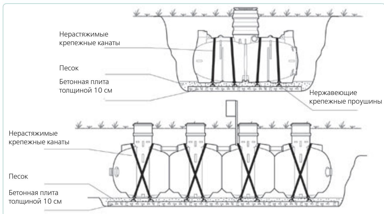
**Система анкерного крепления «Upnor»** позволяет ускорить и упростить анкерное крепление резервуаров в сложных условиях. Комплект принадлежностей для анкерного крепления включает в себя две анкерные плиты, крепежный канат и инструкцию по установке. Для анкерного крепления резервуара объемом 2м<sup>3</sup> необходимо два комплекта принадлежностей, для крепления резервуара объемом 3 м<sup>3</sup> – три, а для крепления резервуара Установки очистки объемом 4 м<sup>3</sup> – четыре комплекта.
