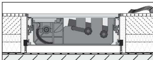
Конвекторы Möhlenhoff серии QSK предназначены исключительно для горизонтального монтажа в конструкции пола. Конвекторы Möhlenhoff серии QSK можно встраивать в конструкцию как монолитного, так и двойного пола.
