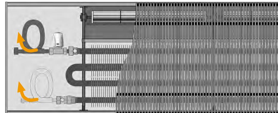
При расширении области соединения на 150 мм мы рекомендуем использовать гибкие шланги, что позволяет легко извлечь внутреннюю часть для целей очистки. Подсоедините шланги к впускным и выпускным клапанам.
