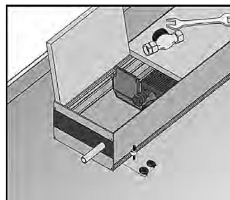
Окончательно удалять монтажную крышку следует только после полного завершения монтажа системного конвектора и окончания строительных работ. Эта мера позволяет избежать загрязнения и повреждения системного конвектора.
