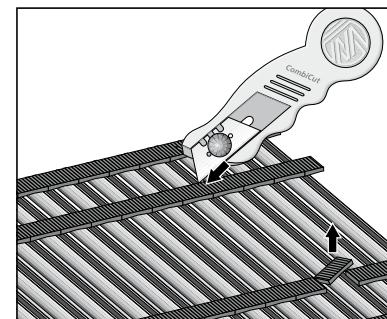
2. Перед монтажом предохранителя в рулонную решетку QSK EC отсоедините соединители рулонной решетки в центре!
