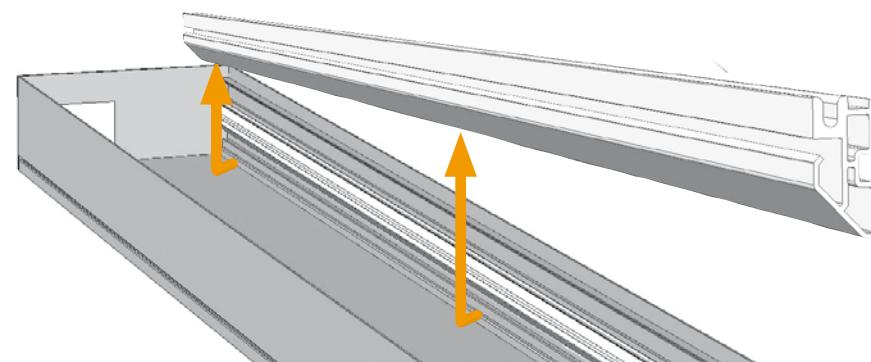
Извлеките перегородочные профили для очистки. Для этого захватите планку профилей снизу и сняйте ее с бокового профиля конвектора. Пополните перегородочные профили влажной салфеткой и снова установите их.
