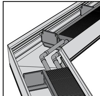
**GPW** Части конвектора для углового стыка поставляются в виде секций.
