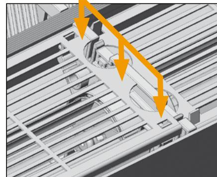
Снимите блокировку защитной решетки. Для этого одновременно надавите на обе блокировки в направлении стрелки (рис. li.), слегка передвигая решетку из блокировки вверх. Проделайте аналогичные действия с другой стороны защитной решетки.
