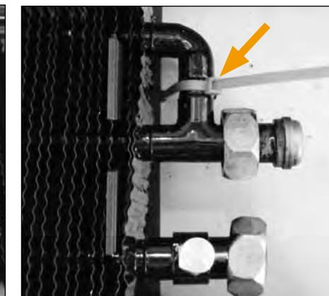
Теплообменник закреплен с двух сторон кабельной стяжкой за лоток конвектора. Снимите кабельную стяжку перед вводом в эксплуатацию!
