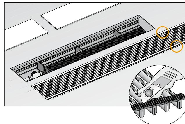
2. С другой стороны, в соответствии с длиной системного конвектора, разрежьте пластиковые соединители.
