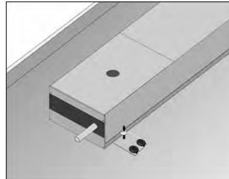
Страна для подсоединения трубопровода обозначена на монтажной крышке точкой («•»).
