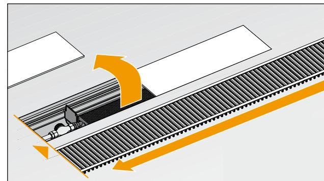
1. Удалите защитные пластины и раскатайте рулонную решетку рядом с конвектором.
