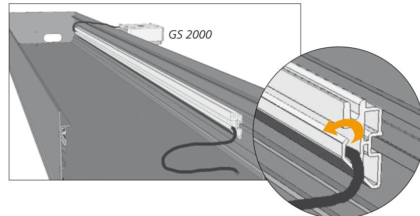
После извлечения внутренней части и GS 2000 удалите из направляющей перегородочного профиля кабель привода.
