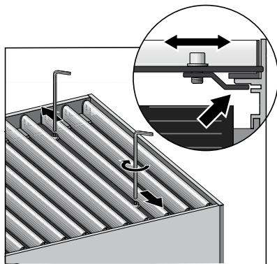
3. Установите декоративную рулонную решетку в лоток системного конвектора. Используя торцевой шестигранный ключ (размер 3), выведите крепежные болты наружу и, таким образом, крепежные планки в выемки боковин. После этого затяните болты.
