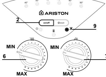
Настройка максимальной мощности отопления
