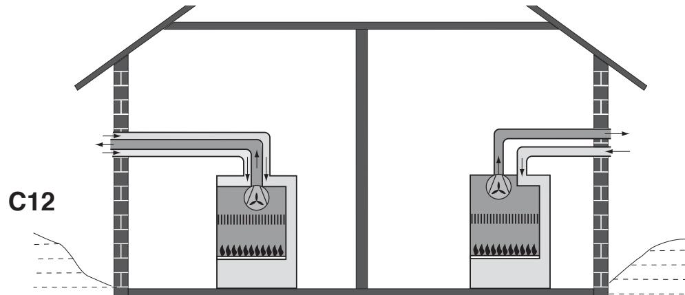
Концентрический или сдвоенный настенный отвод. Выводы сдвоенного отвода должны подвергаться одинаковым ветровым условиям (они должны вписаться в квадрат со стороной 50 см).
