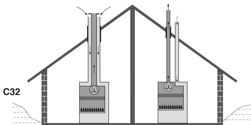
Концентрический или сдвоенный отвод на крыше. Выводы сдвоенного отвода должны подвергаться одинаковым ветровым условиям (они должны вписаться в квадрат со стороной 50 см).
