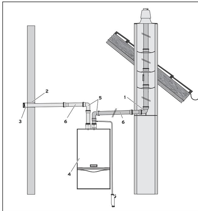
Рис. 6.17 Поддача дутьевого воздуха через наружную стену
