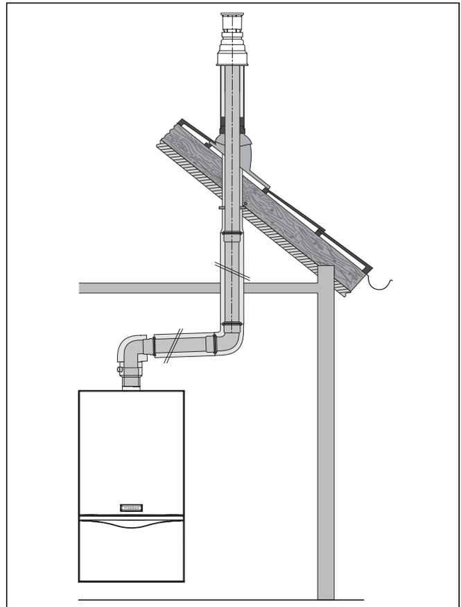
Рис. 5.18 Пример монтажа вертикального кровельного ввода с отводом
