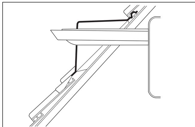
Рис. 5.22 Пример монтажа горизонтального кровельного ввода (слуховое окно)
