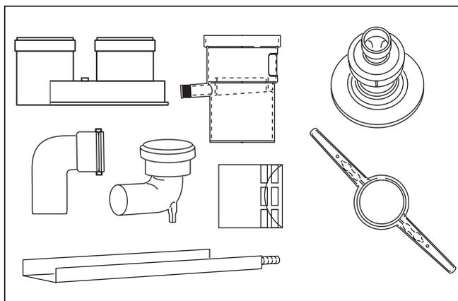
Рис. 6.13 Соединение трубами с трубопроводом Ø 80
