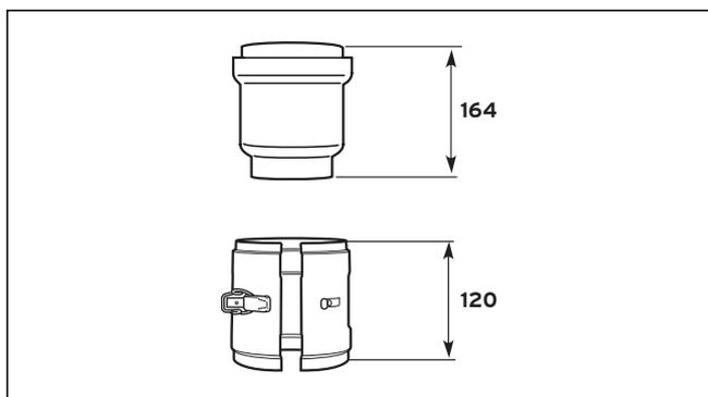
Рис. 5.5 Разделитель, Ø 80/125
