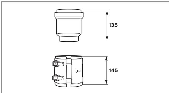
Рис. 4.7 Разделитель, Ø 60/100
