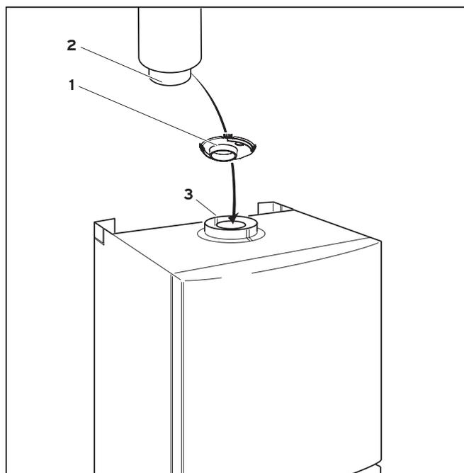
Рис. 5.13 Монтаж заглушек отработанных газов
