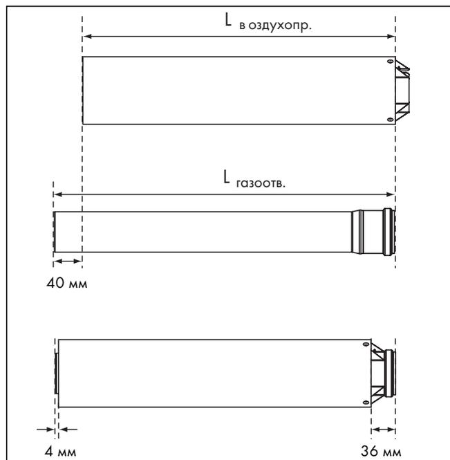
Рис. 4.27 Укорачивание труб
