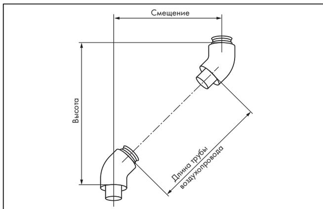
Рис. 5.29 Монтаж колен 45°
