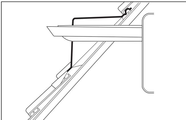
Рис. 4.22 Пример монтажа горизонтального кровельного ввода (слуховое окно)
