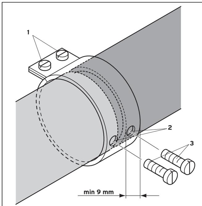
Рис. 5.30 Монтаж хомутов воздухопровода
