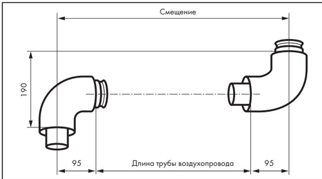
Рис. 5.28 Монтаж колен 87°
