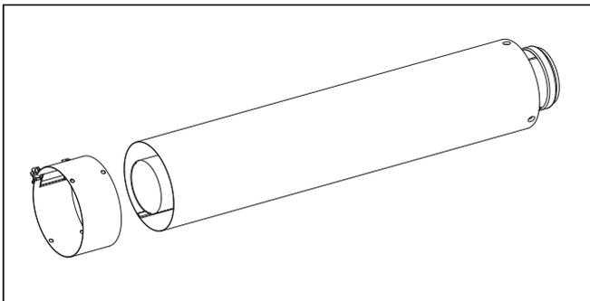
Рис. 4.2 Удлинитель, Ø 60/100
