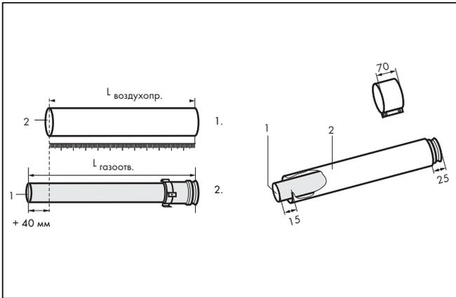
Рис. 5.26 Укорачивание труб
