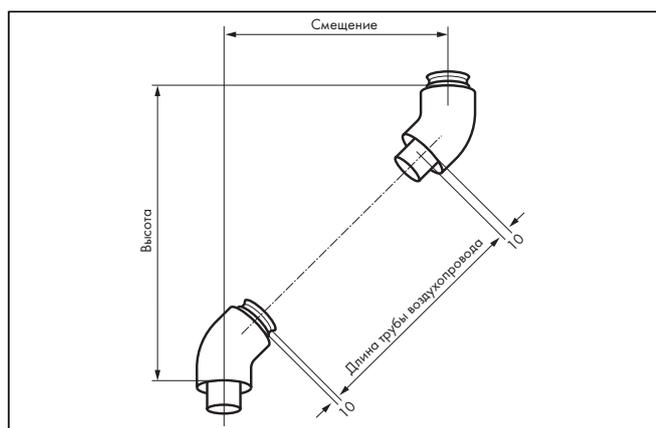
Рис. 4.30 Монтаж колен 45°
