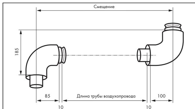
Рис. 4.29 Монтаж колен 90°
