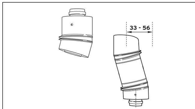
Рис. 4.5 Телескопический отвод
