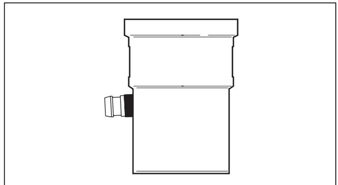
Рис. 6.6 Конденсатоотводчик, Ø 80
