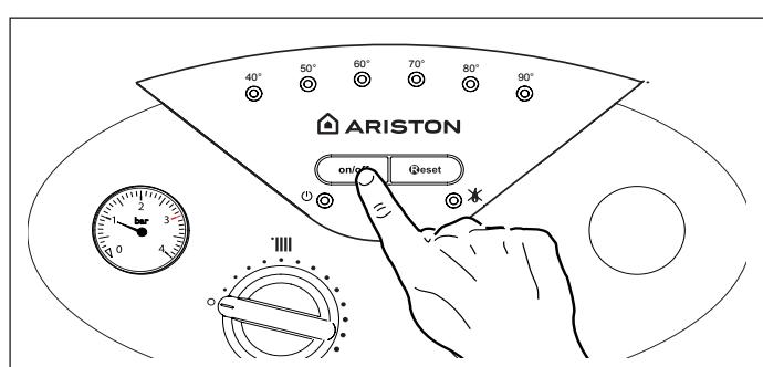
Если примерно через 10 секунд горелка не зажжется, устройства безопасности колонки перекроют подачу газа, и загорится красный СИД «9».
