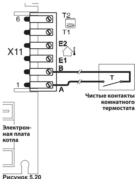
Термостат должен иметь изоляцию класса II (□) или должен быть подсоединен к системе заземления.
