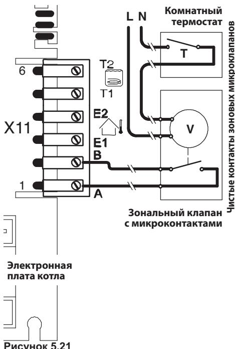
Чтобы подсоединить зоновые клапаны, используйте клеммные колодки комнатного термостата, см. Рисунок 5.21. Электропровода контактов датчика зонового клапана должны вставляться в зажимы "A и B" клеммной колодки комнатного термостата, см. Рисунок 5.21.
