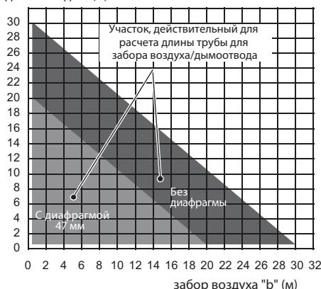
дымоотвод "а" (м) **Модель 32 кВт**
