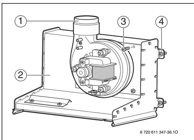
Рис 44 Вентиляторный блок
