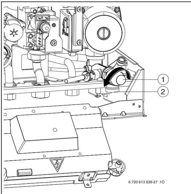
Рис 47 Предохранительный клапан
