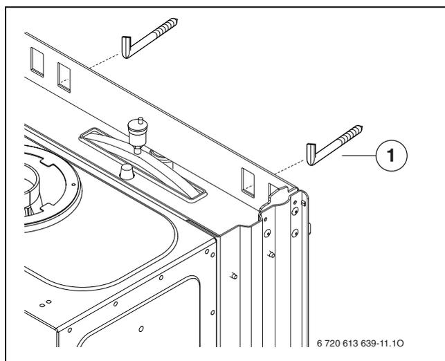
Рис 12 Подвешивание прибора
