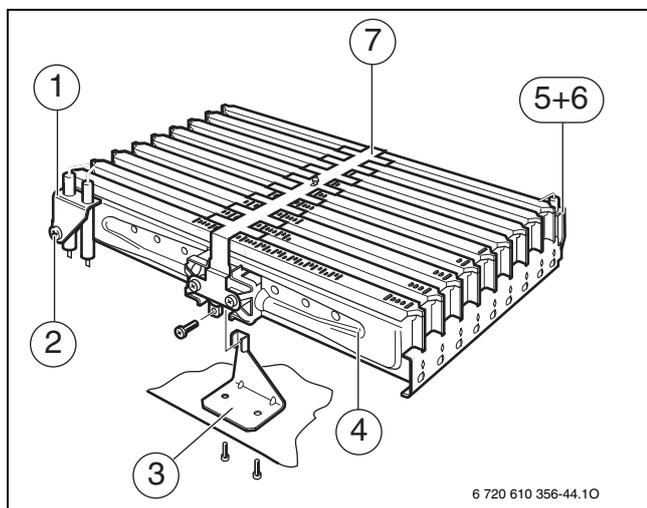
Рис 41 Узел горелки
