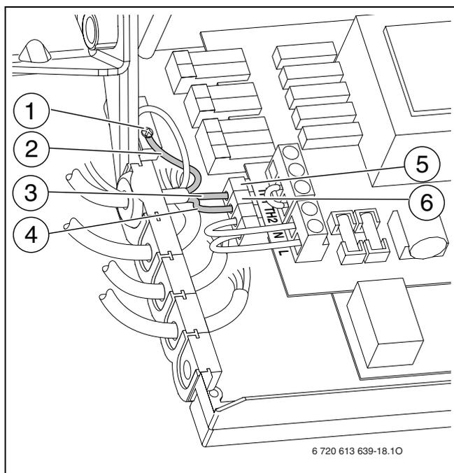
Рис 19 Подключение сетевого кабеля 230 В перем. тока
