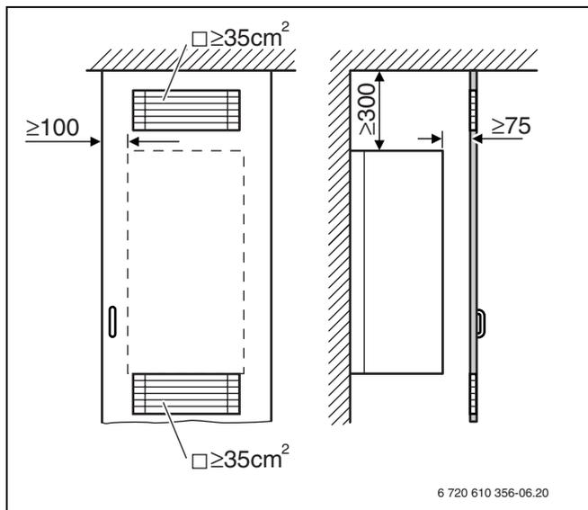
Рис 8 Вентиляционные отверстия при установке в шкафу
